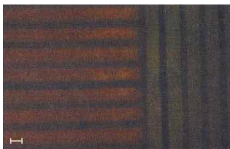
Abb. 2. Photographie eines SiO 2 -Plättchens, das mit zwei fluoreszenzmarkierten Antikörpern beschriftet wurde. Die Antikörper wurden mit der zuvor beschriebenen Methode der Photoaktivierung immobilisiert. Braunrote Fluoreszenz zeigt gebundenes Kaninchen-IgG, grüne Fluoreszenz gebundenes Ratten-IgG an. Die Streifen sind 10 µm breit und durch 10 µm breite Lücken voneinander getrennt. Die schwarzen Bereiche zeigen, daß eine unspezifische Bindung der Antikörper sehr selten ist. Die Länge des Balkens entspricht 10 µm.
